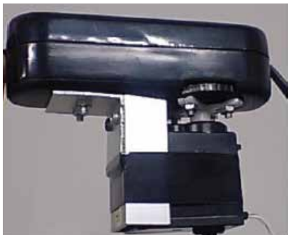
Slika 54. Uređaj za kontrolu osvetljenja u prostoriji
